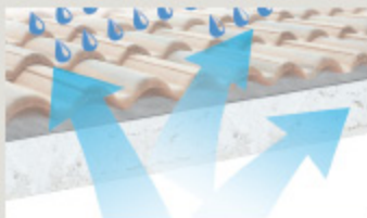
Con DELTA®-LITE PLUS il tetto può respirare. DELTA®-LITE PLUS in ogni situazione «prende» l'umidità dall'interno e la evacua in maniera sicura all'esterno.
