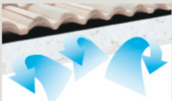
Senza DELTA®-LITE PLUS c'è il rischio che l'umidità non trapassi e che si formi condensa.
