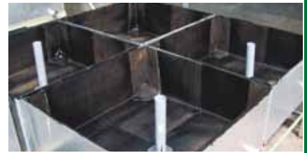
2. Vasche di prova impermeabilizzate
